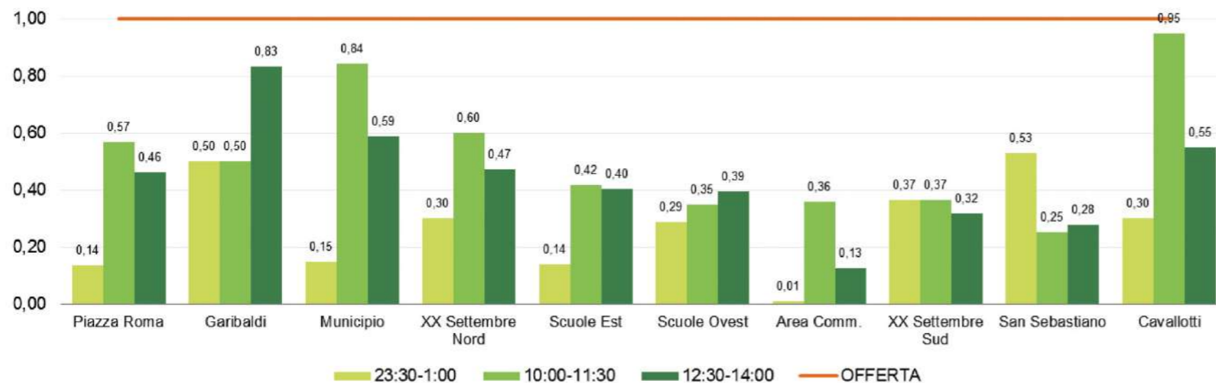
fig.17: Tab.2 - Auto in sosta per fascia oraria e comparto - Rilievo diretto Studio META 2015
