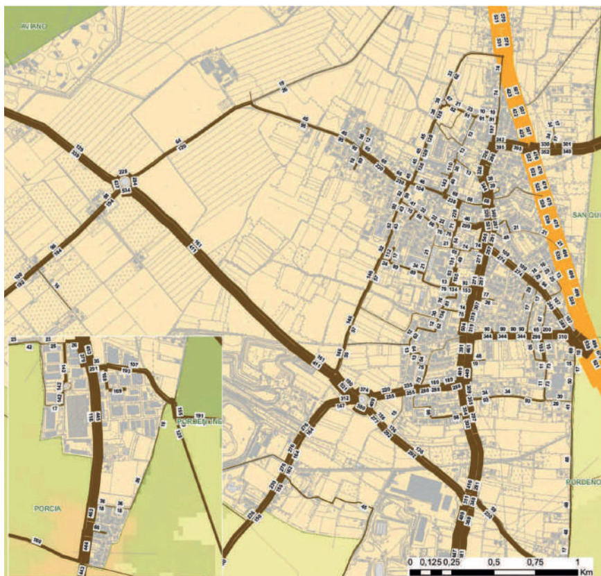
fig.23: Grafo della viabilità principale caricato nell'ora di punta nella situazione esistente
